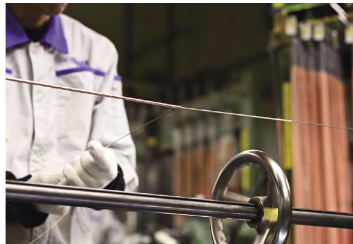
低音部の弦には、明確な音程感と重厚感を併せ持つ、熟練した職人による手巻き巻線を採用。写真は、芯となる鉄線に純度の高い銅線を巻きつけているところ。
