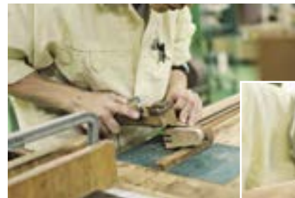
かなでネックの接合部を削って微調整。
