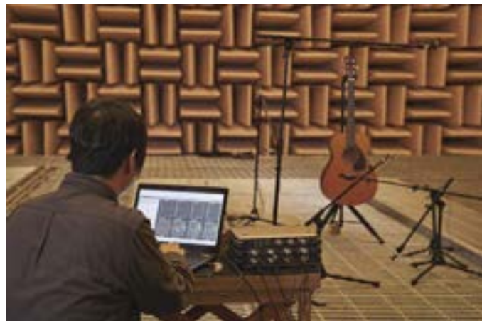
アコースティックギター「FG/FS9」における音響測定プロセス。
